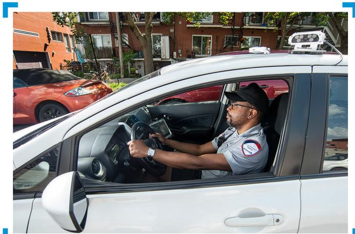
Un véhicule muni d'un système de lecture automatisée des plaques d'immatriculation
