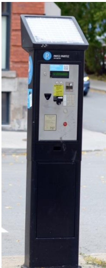
Exemple d'une borne de paiement sur rue.
